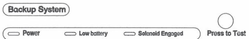
**Abb. 7-6.** Bedienkonsole für die Back-Up Systemkontrolle
